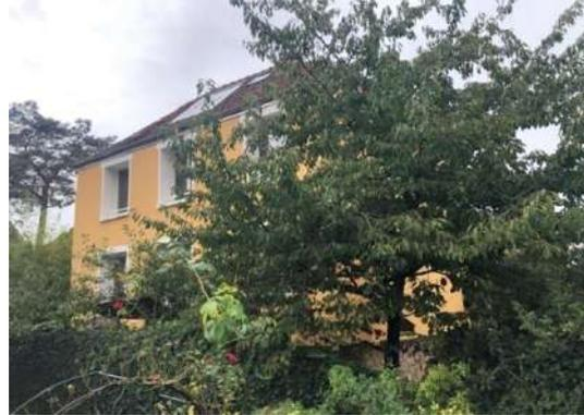
La maison, elle, semble dater du début du XXe siècle. La construction est de composition mixte : le soubassement en pierres meulières, les façades sont en béton avec remplissage mâche fer et briques, non isolé, recouvert d'un enduit ciment et une charpente bois avec une couverture en tuiles traditionnelles. Un jardin entoure l'ensemble.
